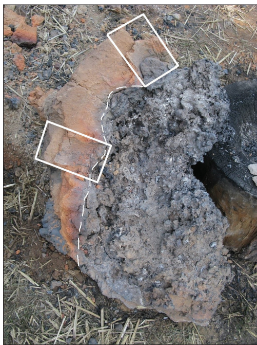
Ryc. 12. Przekrój części ścianek szybu pieca doświadczalnego na poziomie otworów dmuchowych (linia ciągła) z zaznaczeniem zasięgu ich nadtopienia przez żużel (linia przerywana) („Dymarki Świętokrzyskie” w 2014 r.) (fot. i oprac. P. Madera)
