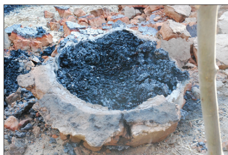
Ryc. 10. łupka żelaza po wydobywaniu z pieca doświadczalnego – widok powierzchni dolnej („Dymarki Świętokrzyskie” w 2013 r.) (fot. A. Kosmalski)
