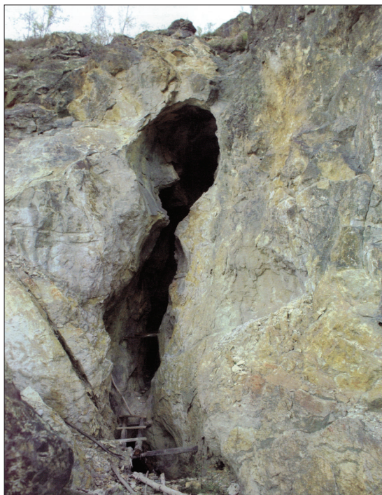
Ryc. 6. Wyrobisko powstałe w wyniku stosowania metody ogniowej, które zostało przecięte przez współczesną eksploatację w rejonie Găuri w masywie Cetate (Rozja Montană, Rumunia) (wg V. Rus 2012, s. 30)
