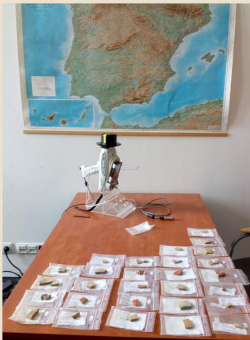
Ryc. 2. Ręczny spektrometr fluorescencji rentgenowskiej na Wydziale Archeologii UAM (fot. M. Krueger).
