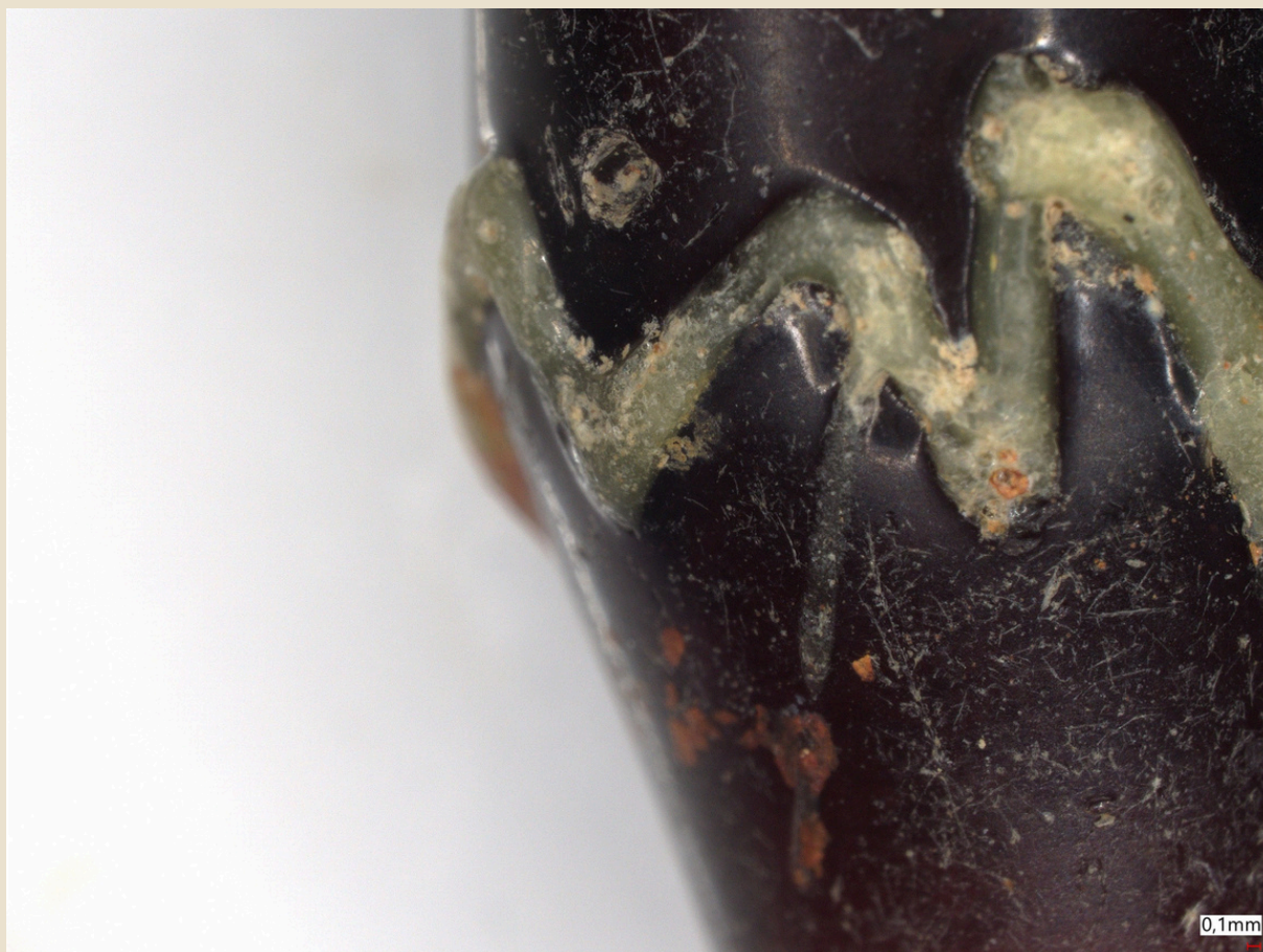
Ryc. 2. Widoczny pod mikroskopem ślad niedokładnego nałożenia nitki szklanej (fot. M. Frankiewicz).
