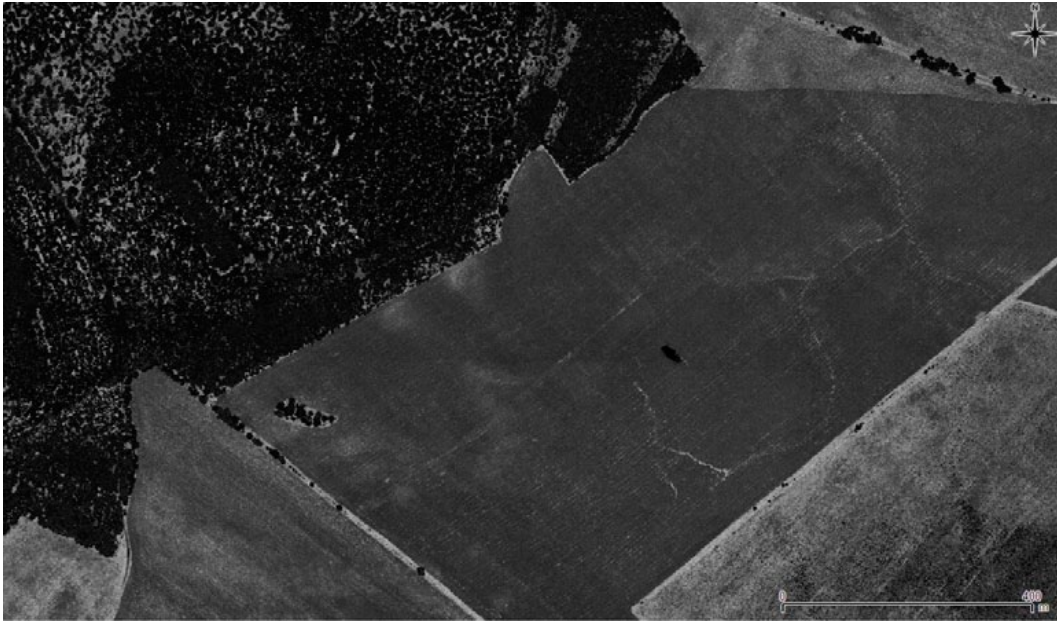
Ryc. 18. Przykład wizualizacji danych intensywności odbicia wiązki lasera – nieistniejący ciek wodny (?) (Źródło: UAM/MGGP Aero).
