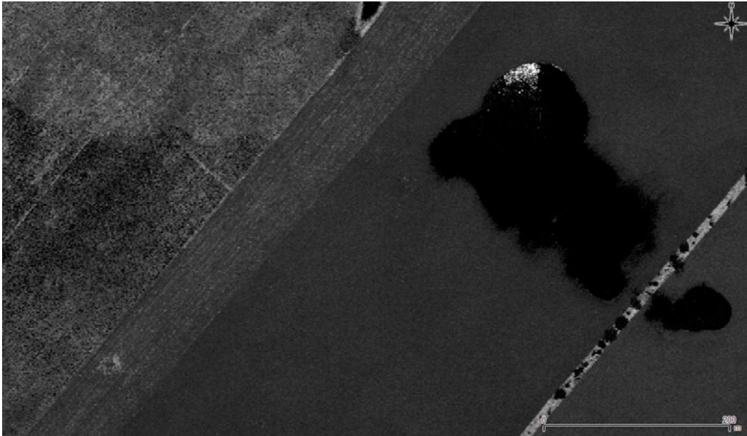
Ryc. 19. Brak pomiaru na terenie uprawnym – obraz intensywności odbicia. Czarny kolor – brak danych (Źródło: UAM/MGGP Aero).
